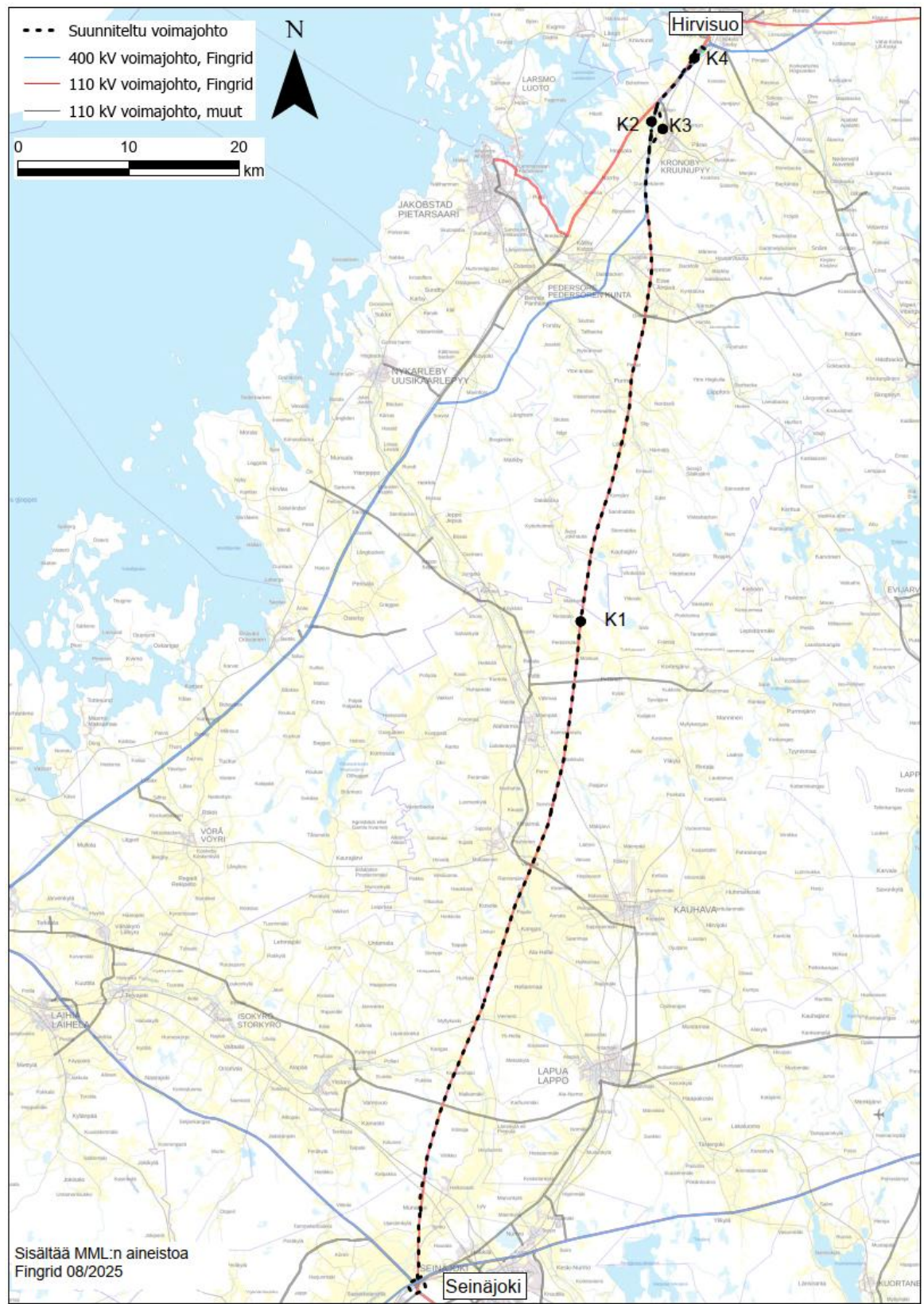
Kuva 7-1. Sähkömagneettisten kenttien laskentakohteet suunnitellulla voimajohtoreitillä.
