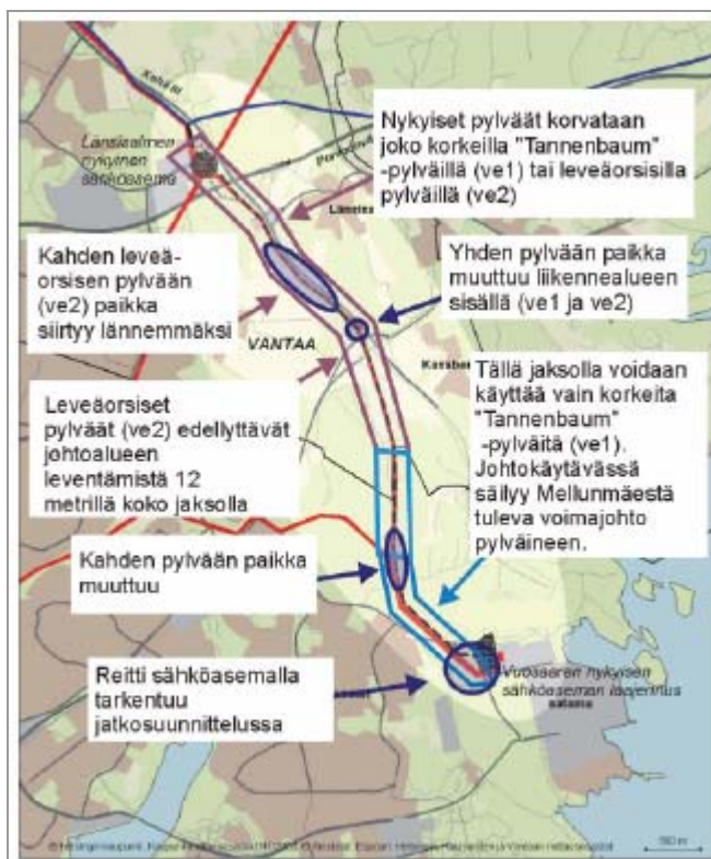
Kuva 1-1. Tarkasteltava voimajohtoreitti ja vaihtoehdotiset pylväsrakenteet.
