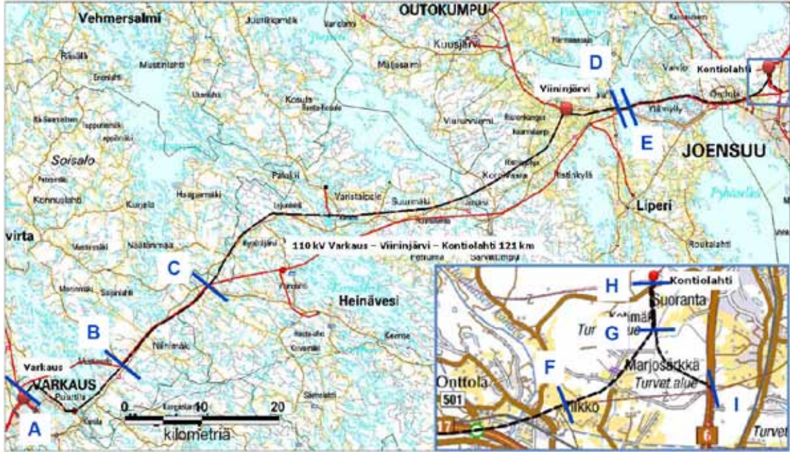
Kuva 5. Uusittavan voimajohdon eri poikkileikkausten sijannit. Poikkileikkaukset on esitetty alla olevissa kuvissa.
