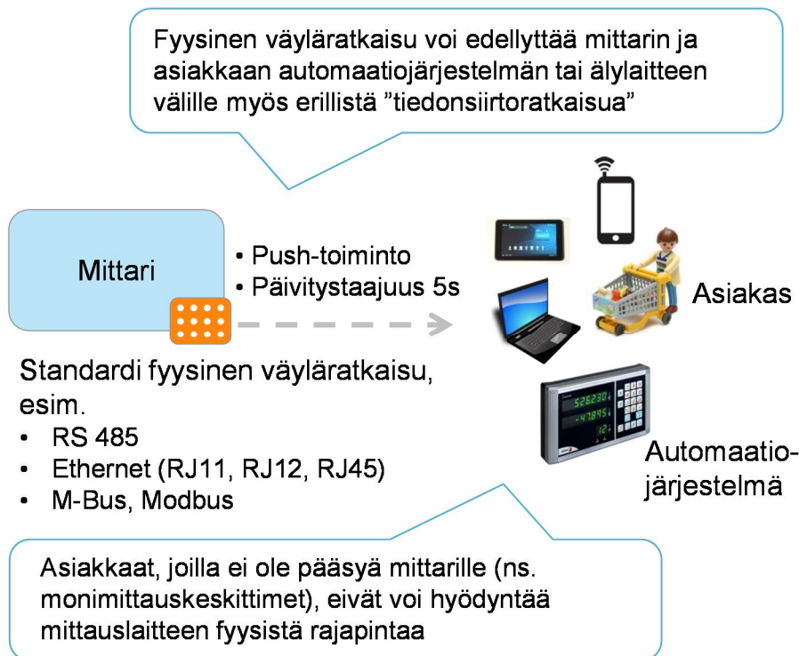
Kuva 9. Periaatekuva mittauslaitteen paikallista tiedonsiirtoväylästä
