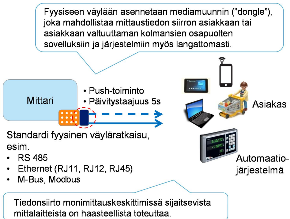
Kuva 11. Periaatekuva tiedonsiirtoväylästä, johon on kytketty mediamuunnin
