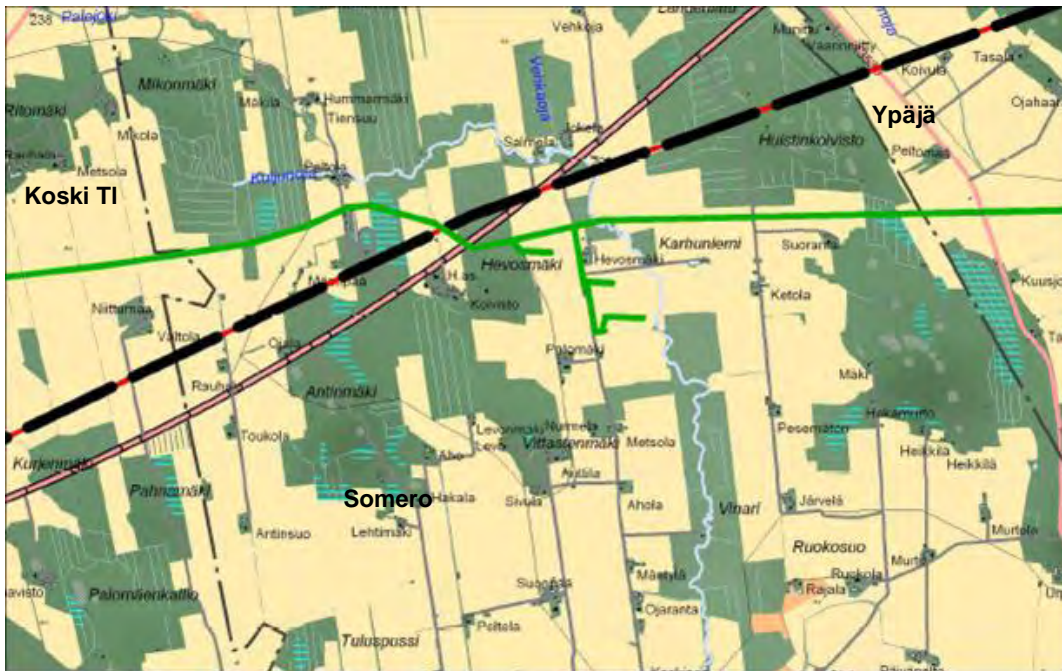
Kuva 1-5. Tarkasteltavan voimajohdon ja kaasuputkihankkeen risteämäkohta Somerolla. Voimajohtohanke on osoitettu mustalla katkoviivalla, kaasuputki vihreällä viivalla ja valtatie 10 vaaleanpunaisella viivalla.
