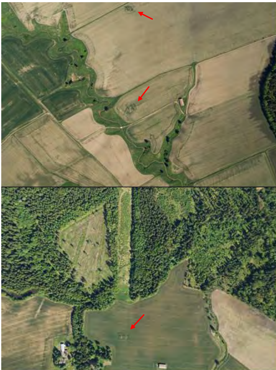
Kuva 4-2. Tarkasteltava voimajohto sijoittuu maa- ja metsätalousalueille. Nuolet osoittavat ilmakuvista nykyiset voimajohtopylväät. Alemmassa kuvassa erottuu metsäalueella johtoaukea.
