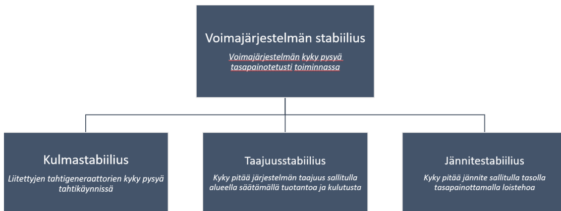
Kuva 2: Sähköverkon stabiiliustarkastelun kolme osa-alueita. (Muokattu lähteestä [8].)
