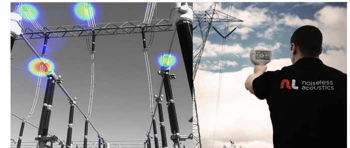
Kuva 18. Esimerkki uudesta kunnossapitoteknologiasta on suomalaisen start-up yrityksen (Noiseless Acoustics) äänikamera, joka pystyy luomaan kuvaa äänestä. Laitteen avulla voidaan mm. löytää häiriölähteitä ja laitteiden piileviä vikoja.
